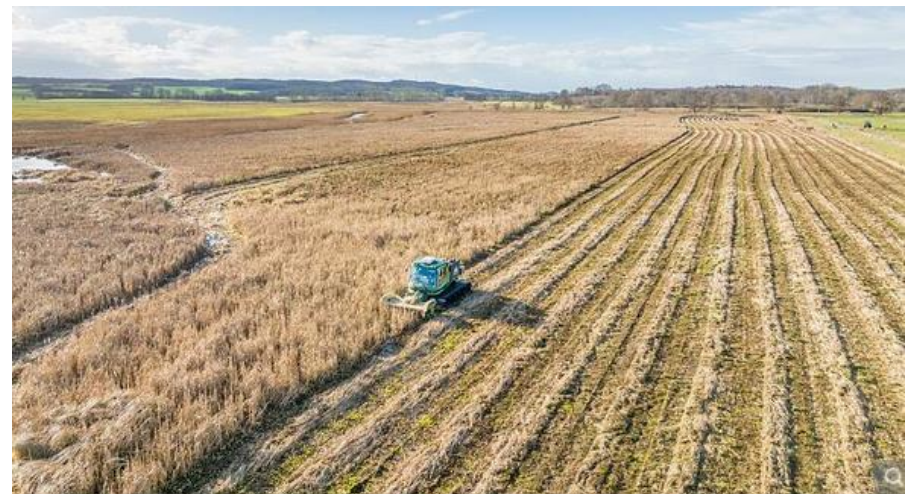
Rohrkolben-Ernte mit einer umgebauten Pistenraupe im Januar 2023 auf einer Versuchsfläche des Greifswald Moor Centrums bei Neukalen in Mecklenburg-Vorpommern
