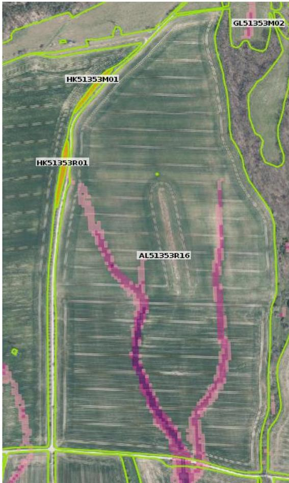
Darstellung Feldblock mit erosiven Abflussbahnen (Karte Bodenschutz in PORTIA) zur Visualisierung der Hanglänge
