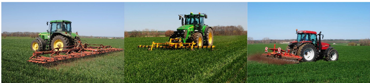
Abb. 11: Mechanische Beikrautregulierung im Winterweizen (Striegel, Hacke, Sternrollhacke)
